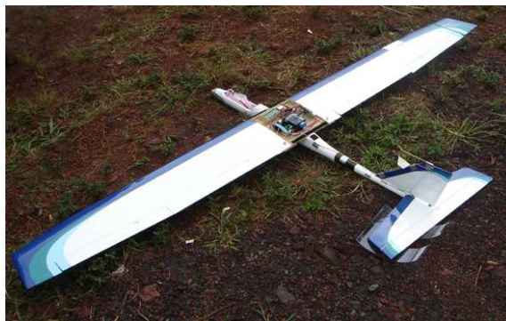
Figura 4: O AqVS – motoplanador elétrico autônomo, embarcado com GPS, sensor de pressão absoluta, microcâmera e unidade de aquisição de dados em vôo.
