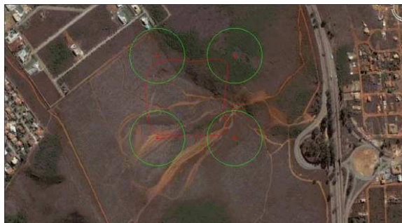
Figura 5: Vôo autônomo passando pelas regiões definidas por quatro waypoints .
