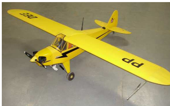
Figura 2: A primeira plataforma utilizada para testes da eletrônica embarcada: um aeromodelo comercial em escala Piper JR3-CUB com eletrônica embarcada. Presa à asa direita pode-se ver a sonda de vento. No dorso, próximo à asa está a antena do radio-modem e próximo ao leme encontra-se a antena do GPS.
